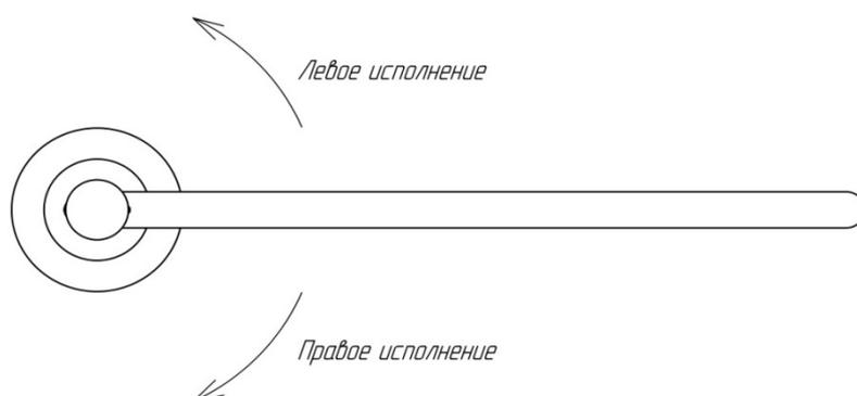
*Рис. 3. Определение варианта исполнения калитки*
